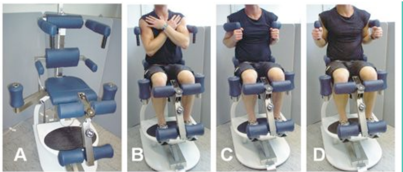
Abb. 2: Kraftmesssystem Myoline® (A) und die Übersicht zur Positionierung in der Testung der Extension (B), der Flexion und Rotation (C) und der Lateralflexion (D).
