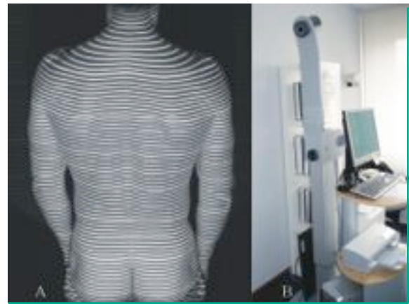
Abb. 4: Person mit Rasterprojektionslinien auf dem relevanten Rückenausschnitt von oberhalb des Vertebra prominens bis unterhalb des Sakrumpunkts (A) und die Hardware des Formetric®-Systems (B) mit den optischen Elementen Diaprojektor (unten) und Videokamera (oben).
