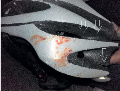
Abbildung 2 Helm des Radfahrers (Falls 2, s. Text), der am Kopf eine Schädelplatzwunde und eine leichte Benommenheit erlitt. Der Helm hatte äußerlich 2 (Pfeile) und innerlich 3 Risse.
