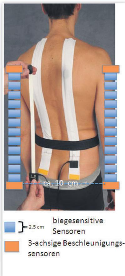
**Abbildung 1** Anlage der Messstreifen mit Ausmessung des Abstands (blaue Kästen: biegesensitive Sensoren, rote Kästen: Beschleunigungssensoren oben und unten).
